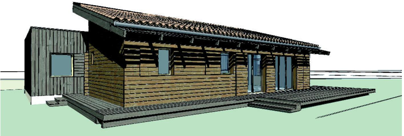
▪ **joints du bardage** : joints creux permettant de jouer avec les ombres et l'arrière plan de la façade ossature bois (apercevoir le matériaux sombre du pare-pluie). Cette méthode accentue l'aspect contemporain en allégeant la peau extérieure, notamment au niveau des angles de la maison.
