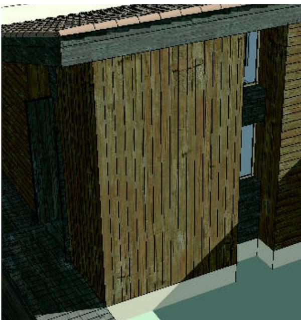
▪ **angle est du volume principal** : cet angle, le plus haut du bâtiment, voit son bardage placé à la verticale, afin d'appuyer le caractère d'élévation. Il est aussi marqué de part et d'autre par deux « failles », une dans le pignon est, marquant l'entrée, et l'autre dans le mur nord. Ces retraits de façade font ressortir cet angle et permettent un traitement différent des baies.
